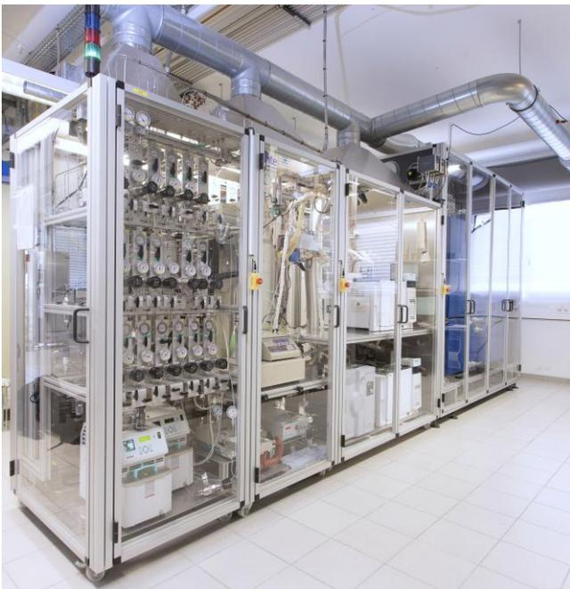
Abbildung 1: 16-fach Hochdurchsatzanlage
