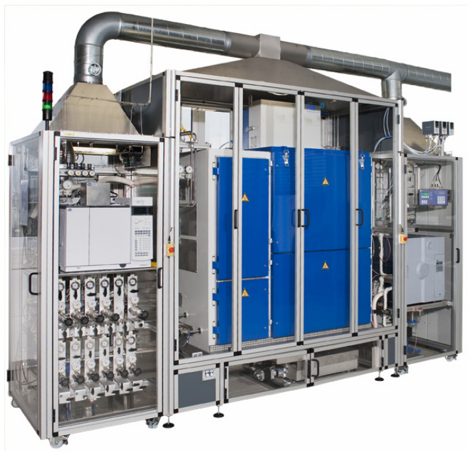
図 1 - hte X4500 水素化反应用トリクルベッド触媒試験システム
