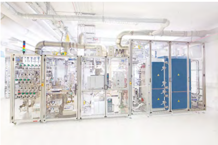
Abbildung 1: flexibles 16-fach Hochtemperatur-Testsystem
